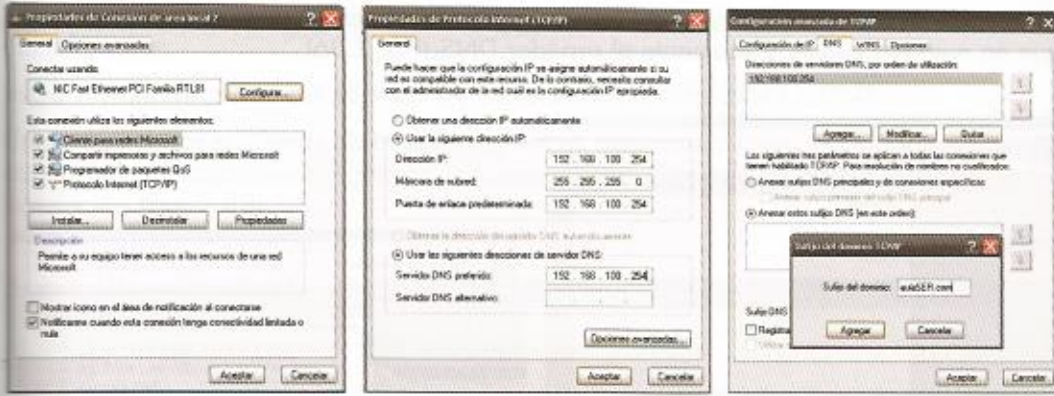
Fig. 2.33. Acceso a la configuración de las propiedades de la conexión de red.
